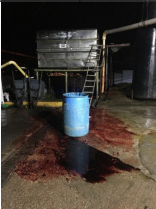
Fotografía 12. Residuos líquidos de agua sangre, mezclados con agua lluvia, por escorrentía
